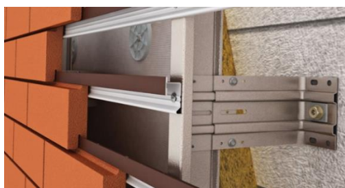
Рисунок 5. Утепление вентилируемым фасадом
