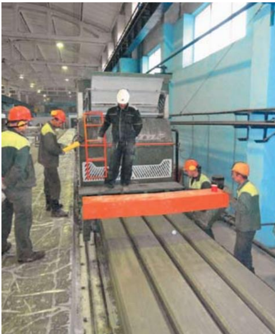
Бір амалмен Вибрациялы қалыптау әдісімен қадалар әзірлеу
